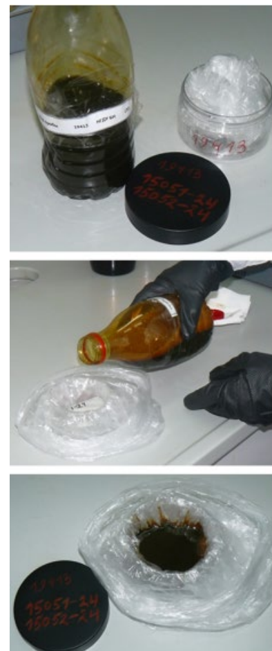
Рисунок 14. Изготовление пробо-образцов нефтью
